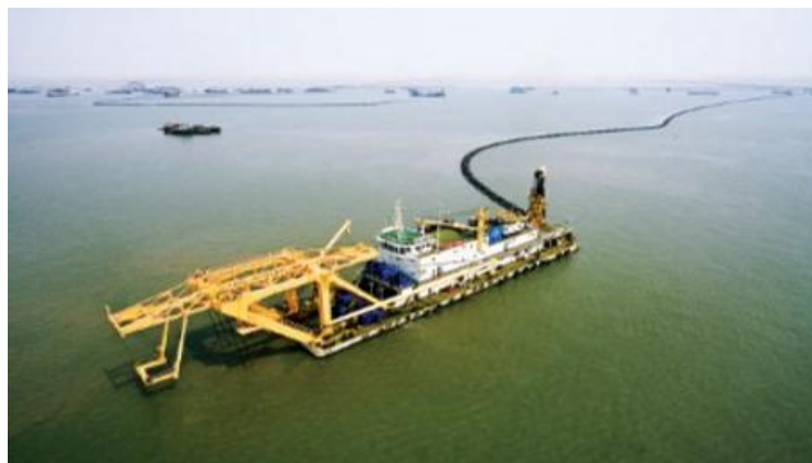
图 3.2-18 绞吸式挖泥船施工示意图
